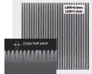
マルチパターニング技術により 線幅11nmのパターンを実現
