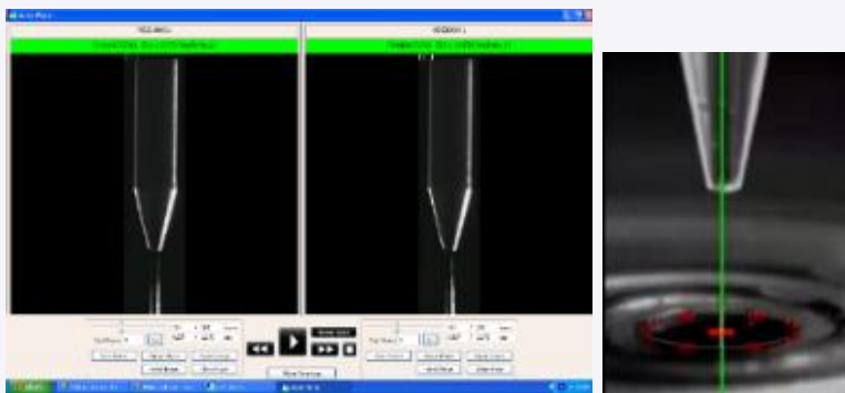
画像処理技術を使った薬液吐出状態のモニタリング
