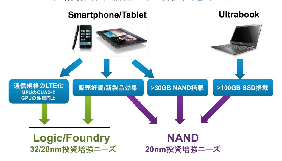
\*LTE (Long Term Evolution): 次世代の携帯電話向け高速データ通信規格。現在、世界中の通信業者が導入を予定。
