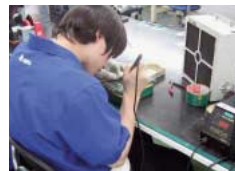
鉛フリーはんだの手はんだ付け作業風景
